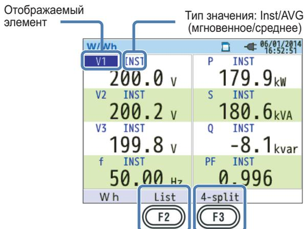
Выбранные четыре или восемь измеренных значений отображаются на одном экране. Измеренные значения проще считывать, так как текст больше, чем на экране списка.
