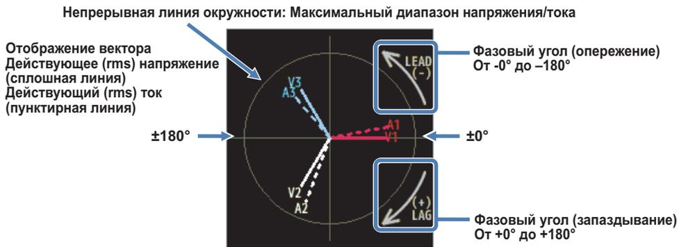
Окружность (сплошная линия) представляет собой максимальные значения диапазонов напряжения и тока. Длина линии представляет собой действующие (rms) значения напряжения и тока. Угол между линиями представляет собой фазовое соотношение применительно к V1. Для 3P3W3A/3P4W, также отображается коэффициент несимметрии (неуравновешенности).
