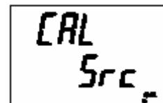
**Шаг 10:** Символы **0** и **FS** прекращают мигать, возвращая калибратор в состояние, представленное на шаге 4. Используя селекторный переключатель функции выберите следующий диапазон. Повторив шаги с 4 по 9, можно настроить функцию генерирования, назначенную для этого диапазона.
