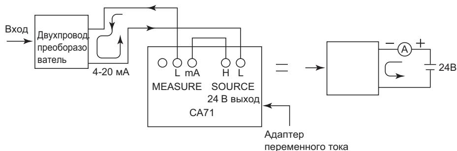
Использование калибратора в качестве источника питания контура
