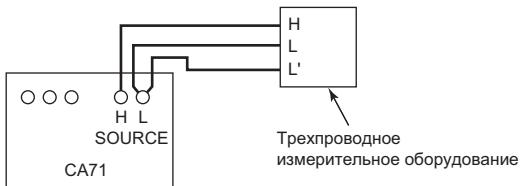
Трехпроводное подключение для генерирования сигнала сопротивления
