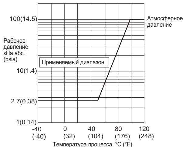
Рисунок 1-2. Температура процесса и рабочее давление [для модели EJX530A]
