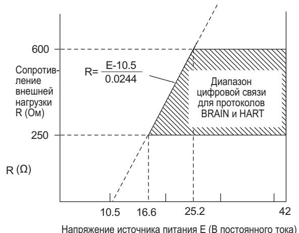
Рисунок 2. Связь напряжения питания и сопротивления внешней нагрузки
