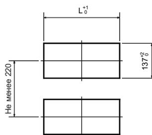
Ширина посадочного отверстия панели при монтаже в ряд
