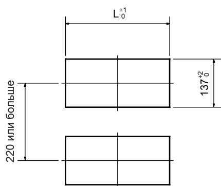
Ширина посадочного отверстия панели при монтаже в ряд
