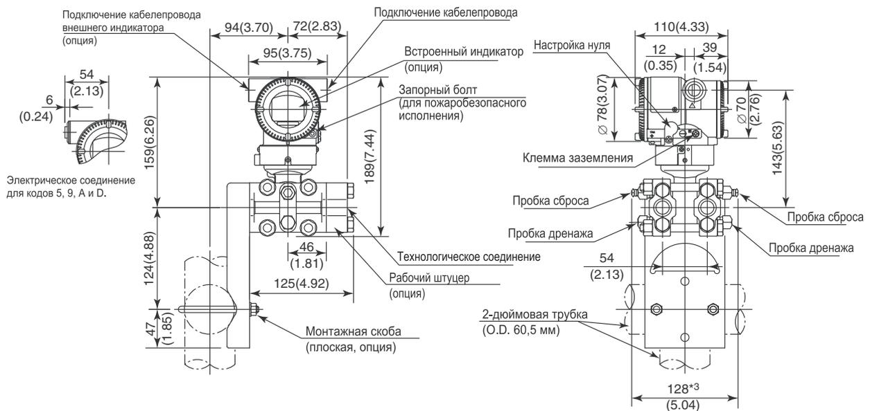
\*1: Если выбран код монтажа 8, то расположение сторон высокого и низкого давления противоположно показанному на рисунке (т.е. сторона высокого давления находится справа).
